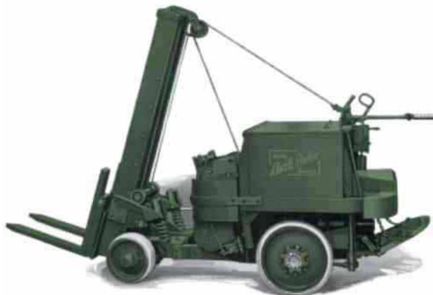
Un **chariot élévateur** est un appareil de levage et de manutention destiné au transfert de charges dans les usines ou les entrepôts de stockage. Il sert principalement au transport de produits finis depuis les chaînes de fabrications vers les lieux de stockage, au chargement et au déchargement.
