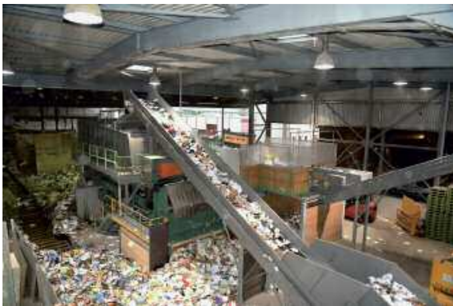
La nouvelle machine de tri optique pour papier/carton de l'entreprise Retripa
