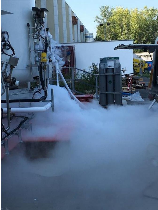
Choc thermique avant le test d'étanchéité d'une pièce
